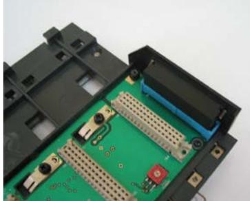
Figure 3.11 - DF2 terminator installed
