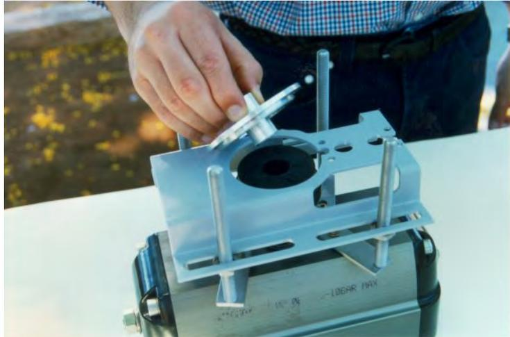
7 - Ajuste el soporte del posicionador usando el dispositivo centralizador y las tuercas para regular la altura del soporte.
