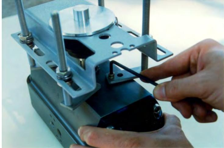
**10** - Apriete los tornillos del soporte del posicionador para fijar las muelas.
