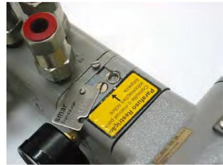
3. Retire el tornillo de la restricción con la herramienta adecuada;
