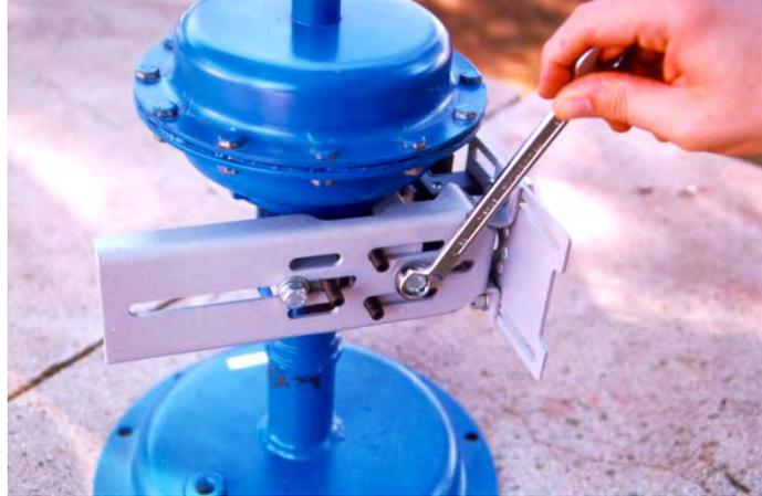
**11** - Monte el posicionador en la placa de sujeción apretando los tornillos Allen. Si prefiere, retire la placa de sujeción para facilitar el montaje.
