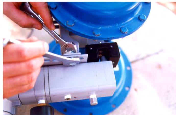
**13** - Alimente el actuador con presión equivalente a la mitad del curso. Regule entonces la altura del posicionador para que las flechas existentes en el Imán y en el posicionador coincidan.
