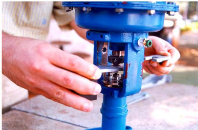
**4** - Apriete el tornillo Allen que sujeta las dos partes del soporte.
