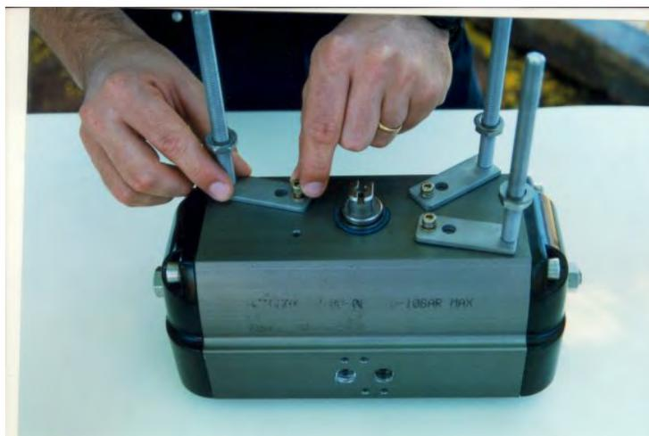
2 - Monte el soporte del imán en la extremidad del actuador (NAMUR).
