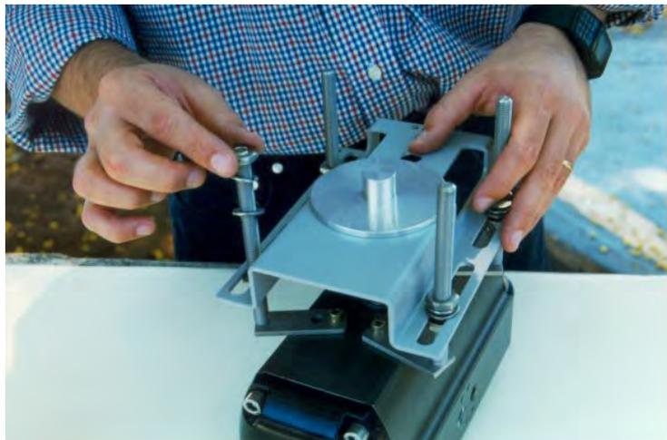
**9** - Apriete los tornillos de las muelas para sujetarlas al actuador.
