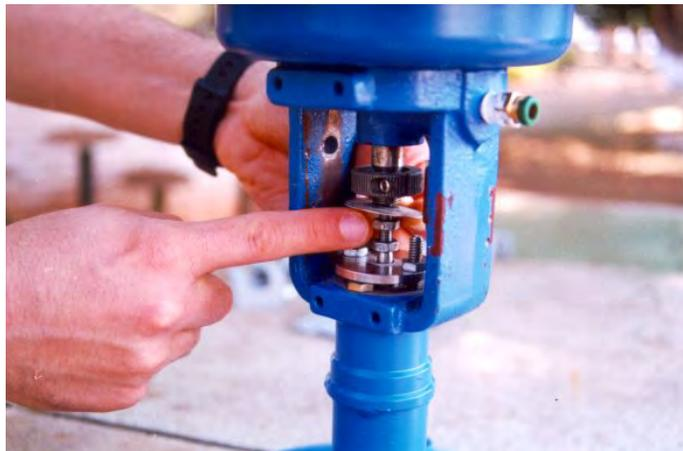
3 - Coloque el soporte en el vástago de tal forma que las tuercas sujeten el soporte del Imán
