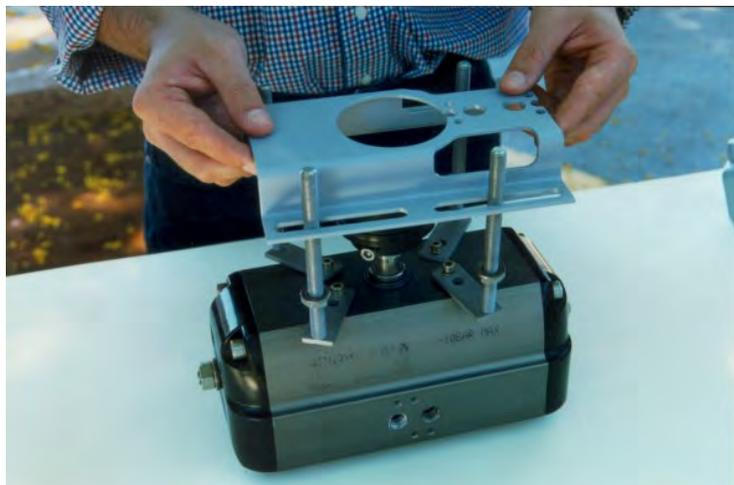
6 - Use el dispositivo centralizador para tener el soporte centralizado con el imán.
