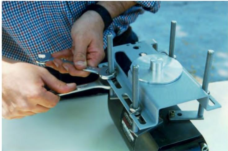
**11** - Retire el dispositivo centralizador y apriete el posicionador en el soporte.
