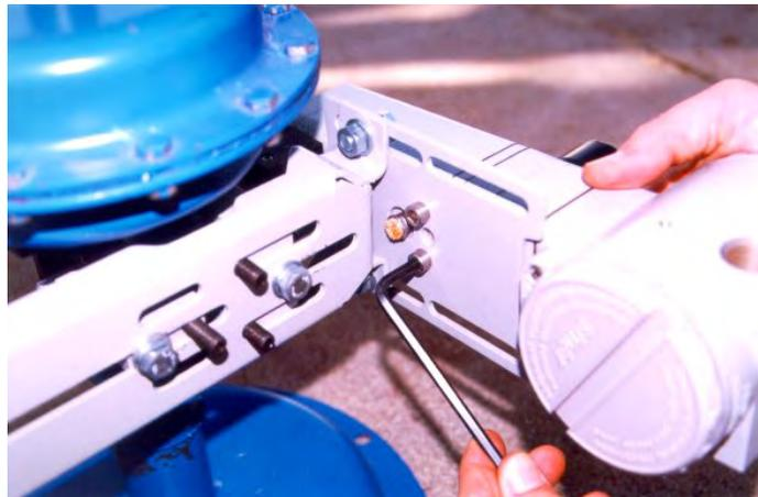
**12** - Regule el centro del pico Hall con el centro del Imán moviendo la placa de sujeción del posicionador. (Observe el diseño).
