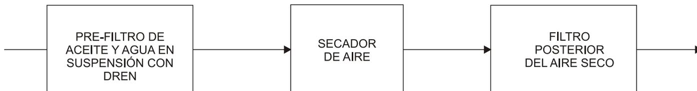
Figura 1.14 – sistema de Acondicionamiento de Calidad de Aire
