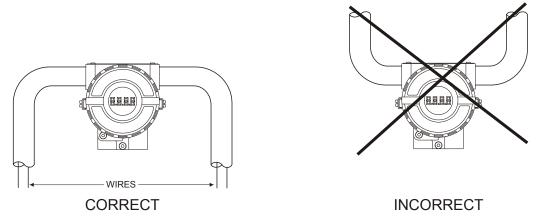
Figure 1.10 - Conduit Installation Diagram.
