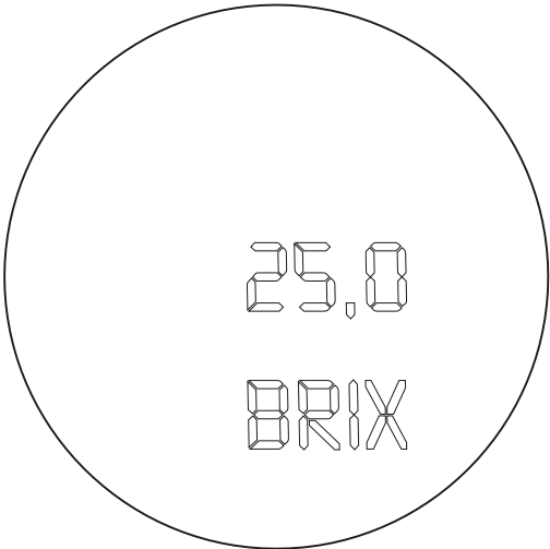
Figura 2.4 - Modo típico del Display mostrando la PV, en este caso 25.0 BRIX
