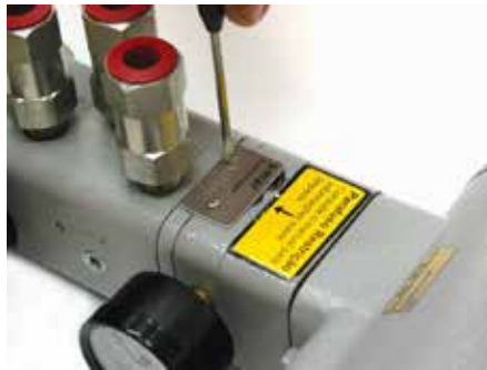
Figura 4.21 – Removendo a placa que protege a Restrição
