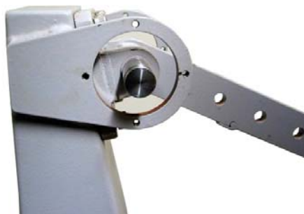
Figura 1.16 - Suporte para Montagem e fixação do Ímã Rotativo
