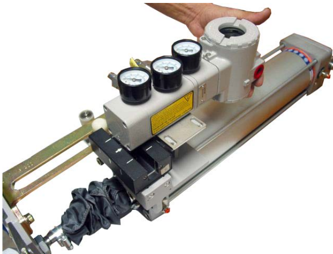
Figura 1.9 – Montagem do Posicionador no Cilindro
