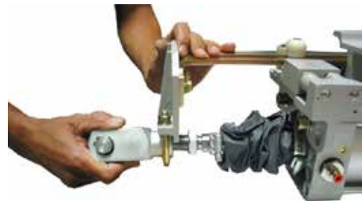
Figura 4.6 – Tirando a Ponteira do Eixo do Cilindro
