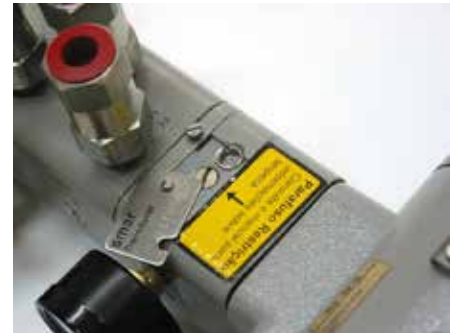
Figura 4.22 – Placa de Proteção da Restrição retirada
