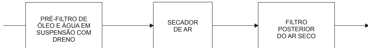
Figura 1.41 - Sistema de Condicionamento da Qualidade do Ar
