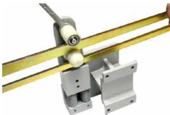
Figura 4.9 – Desmontagem do Rolete Fixo
