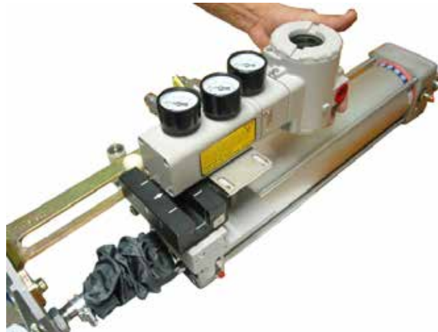
Figura 4.2 – Desmontagem do Posicionador do ACP do Cilindro
