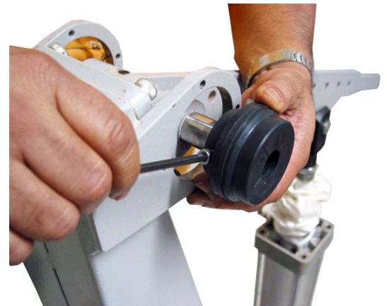
Figura 1.19 – Detalhe da Fixação do Parafuso (não apertar)
