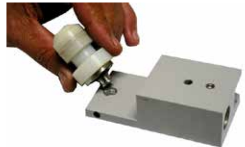
Figura 4.14 – Desmontagem do Rolete Móvel
