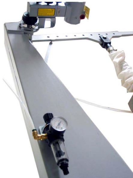
Figura 1.30 - Instalação do Filtro de Ar
