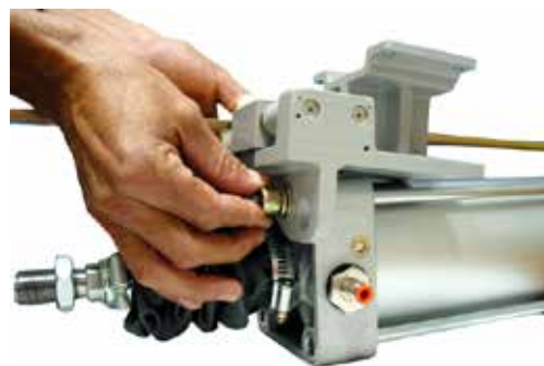
Figura 4.8 – Soltando os Parafusos Allen
