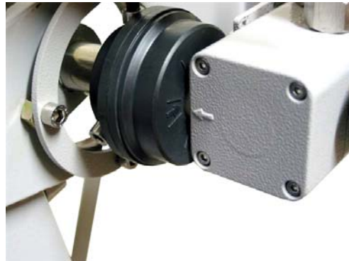
Figura 1.26 – Detalhe da Fixação dos Parafusos do Ímã Rotativo
