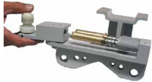
Figura 4.12 – Desmontando o Subconjunto da Base Móvel
