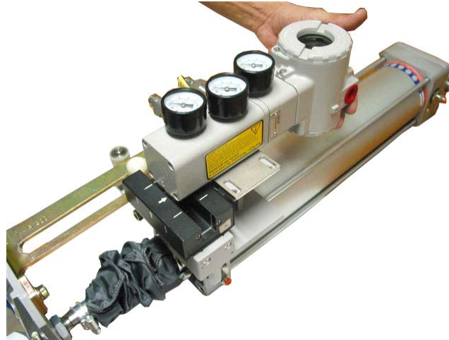
Figura 5.2 – Desmontagem do Posicionador do ACP do Cilindro
