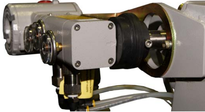
Figura 1.23 - Detalhe da Instalação do Ímã
