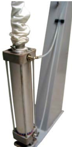
Figura 1.29 - Detalhe das Conexões dos tubos de Suprimento de ar e Conexões de Saída
