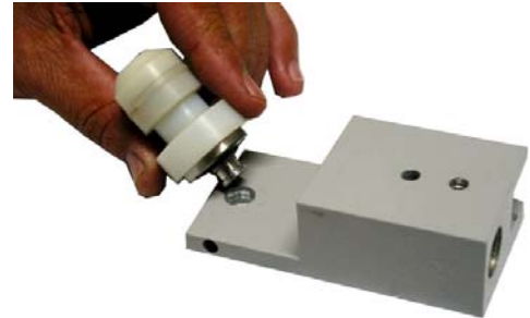
Figura 5.14 – Desmontagem do Rolete Móvel
