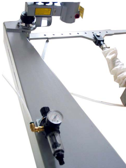
Figura 1.30 - Instalação do Filtro de Ar
