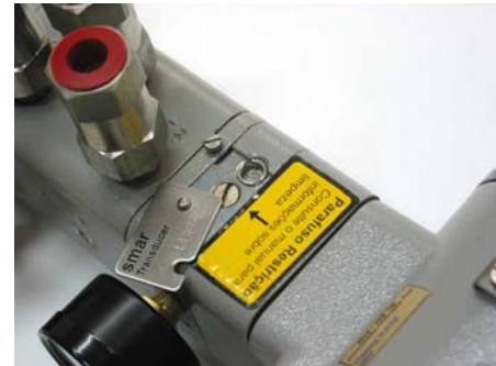
Figura 5.22 – Placa de Proteção da Restrição retirada
