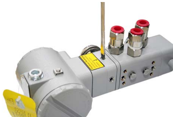
Figura 5.23 – Removendo o Parafuso da Restrição
