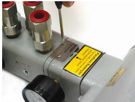
Figura 5.21 – Removendo a placa que protege a Restrição
