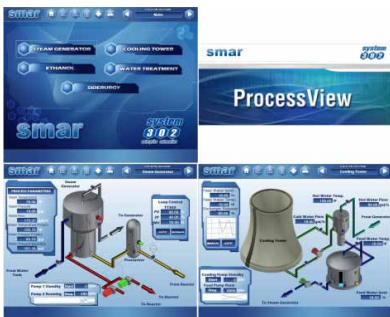
ProcessView Sistema de Operação / Supervisão
