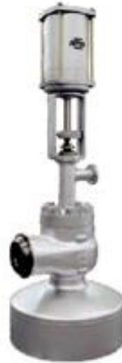
La válvula de acondicionamiento de la serie VCVB-1 combina la función de reducción de presión y de atemperamiento de vapor, lo que permite un control preciso de la temperatura y la presión en un solo sistema. Por lo general, se aplican en plantas termoeléctricas, como bypass de turbinas o acondicionamiento de vapor auxiliar en procesos generales.
